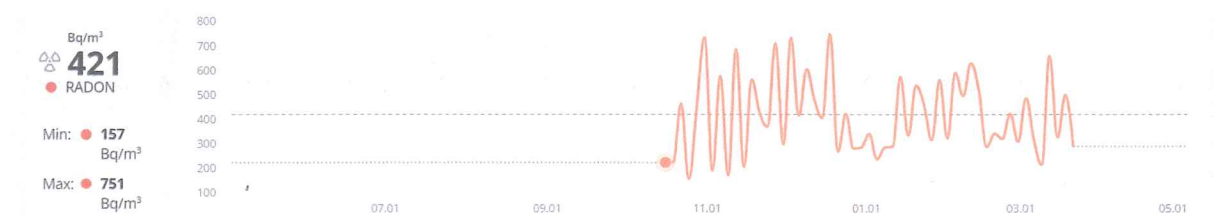
Slika 6: Interne meritve radona z merilniki Airthing wave plus v igralnici Čebelice v obdobju od 18. 10. 2022 do 24. 3. 2023.
