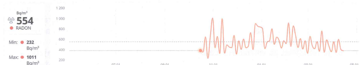
Slika 8: Interne meritve radona z merilniki Airthing wave plus v igralnici Mucki v obdobju od 18. 10. 2022 do 17. 4. 2023.
