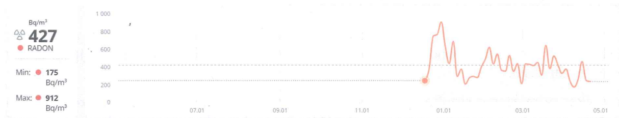
Slika 10: : Interne meritve radona z merilniki Airthing wave plus v igralnici Metulji v obdobju od 18. 12. 2022 do 23. 4. 2023.
