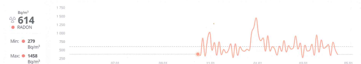
Slika 7: Interne meritve radona z merilniki Airthing wave plus v igralnici Miške v obdobju od 18. 10. 2022 do 17. 4. 2023.
